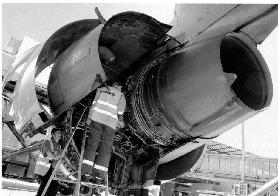
Auch SR Technics hält nach wie vor in verschiedenen Bereichen Ausschau nach Fachleuten. Hier erledigen zwei Flugzeugmechaniker einen Service an einem PW4000-Triebwerk.
